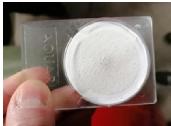
Figura 3 – In condizioni di funzionamento reale, le misurazioni del particolato in moderni impianti automatici, correttamente progettati e mantenuti, confermano fattori di emissione di PM10 estremamente bassi e privi di componente carboniosa organica (catrami).
